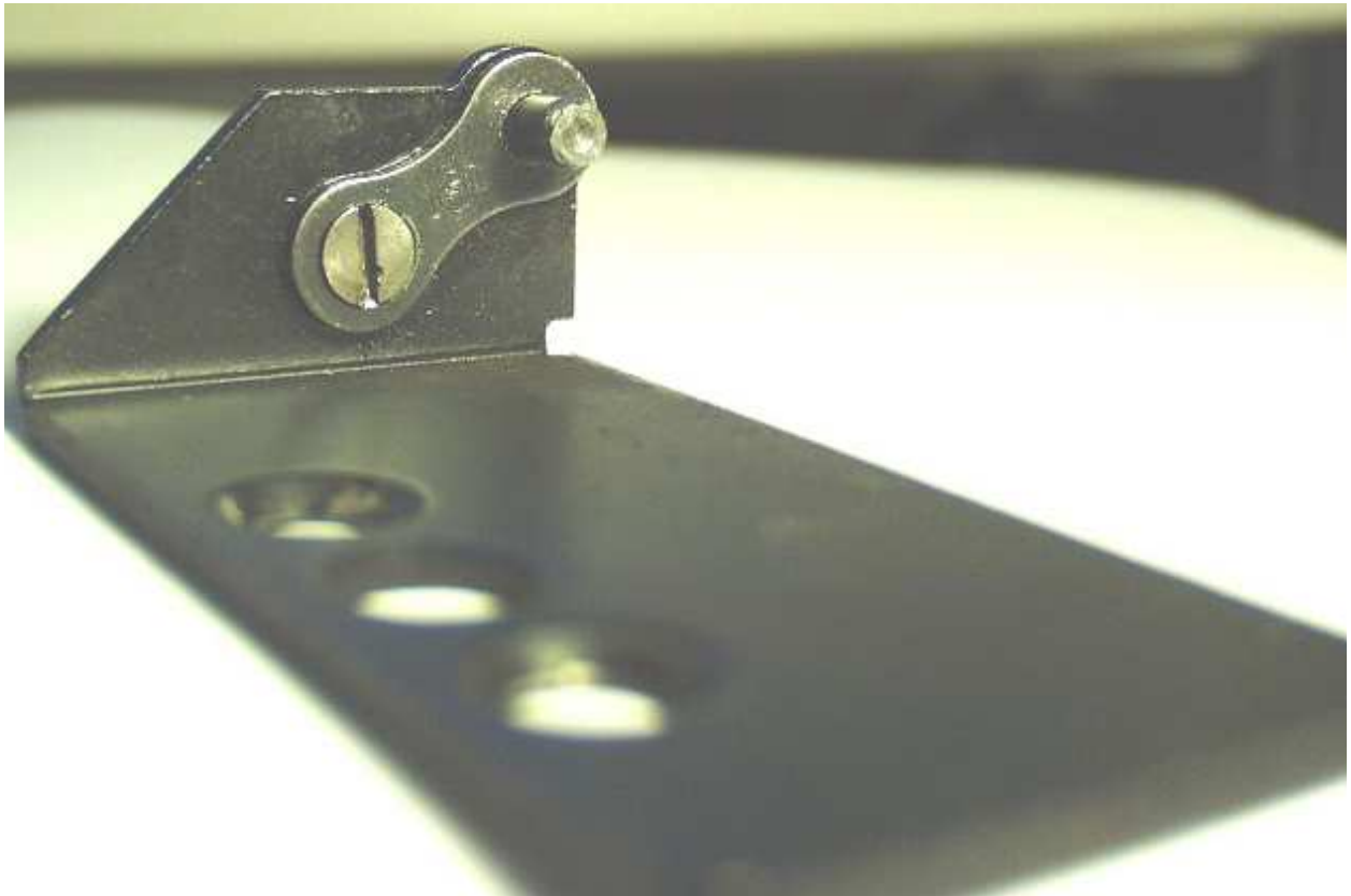
Bild 2 Die neue Türangel am Türbefestigungswinkel
