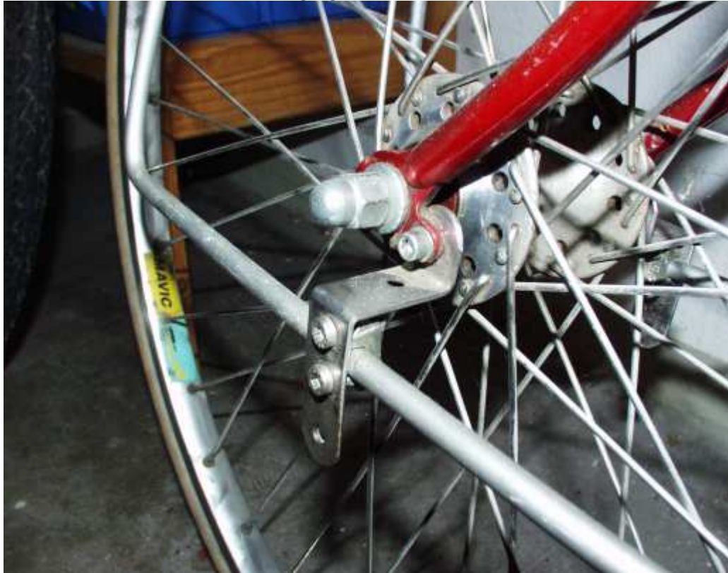
Bild 3 Schraubbefestigung am Gitane-Tandem vorn
