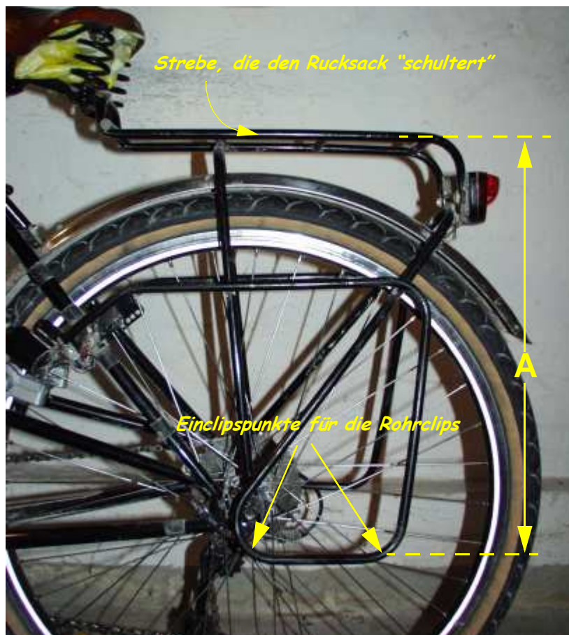
Bild 6 Der Nöll-Gepäckträger am gleichnamigen Tandem
