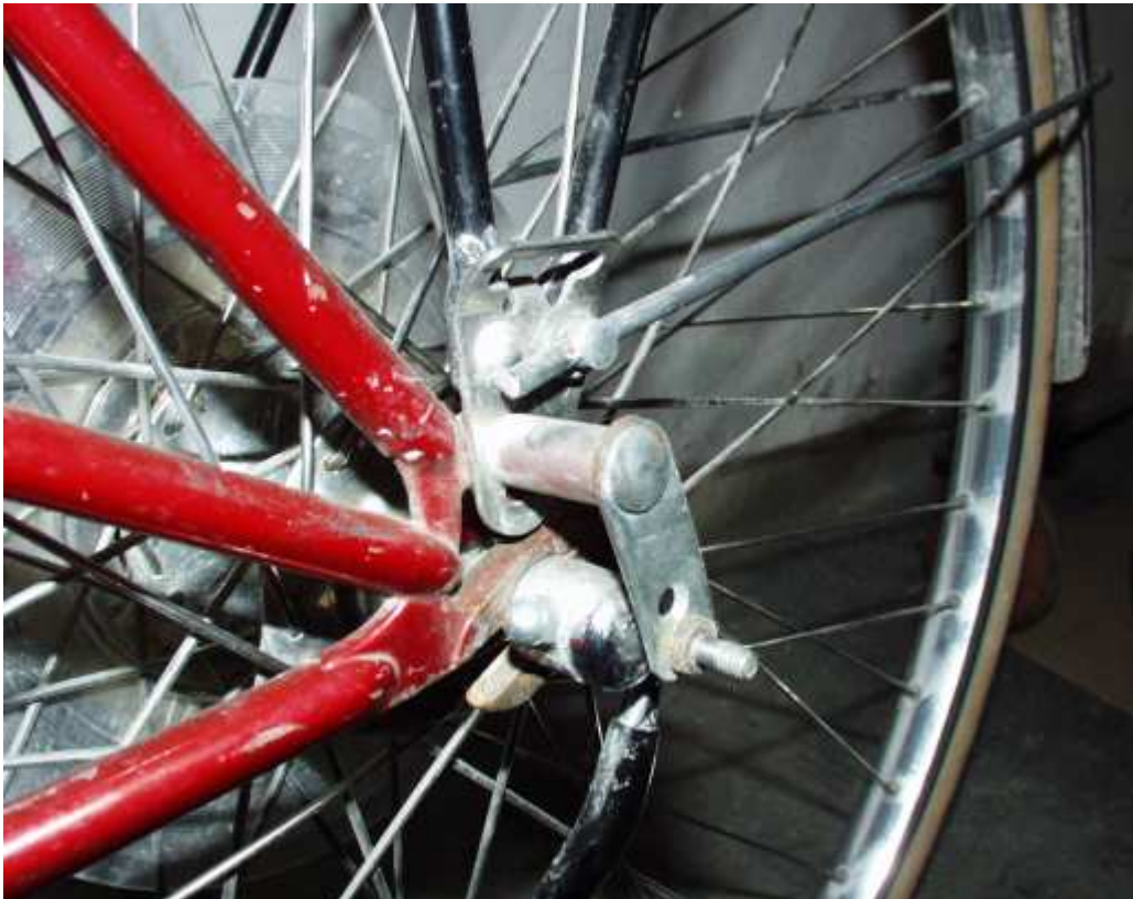
Bild 5 Schraubbefestigung am Gitane-Tandem hinten
