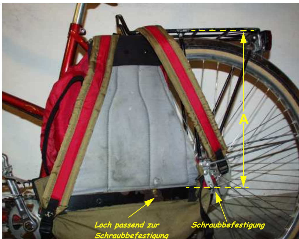
Bild 4 Rucksackmontiermöglichkeit am Gitane-Tandem hinten
