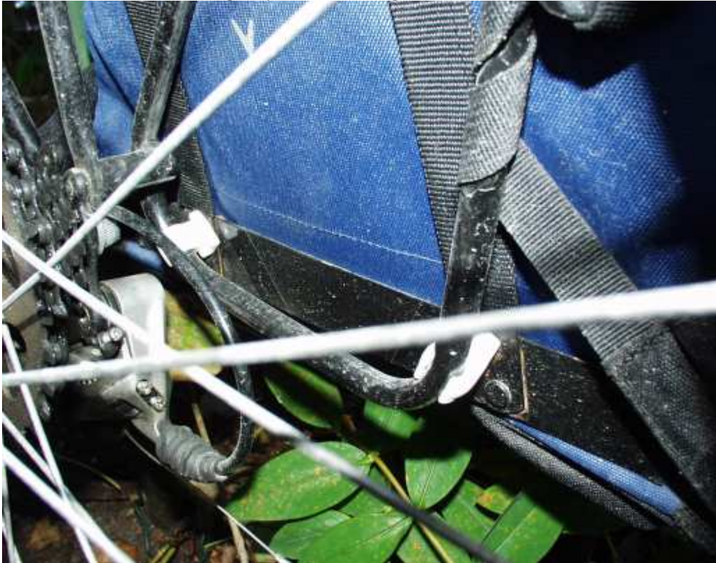
Bild 9 Befestigung eines Clip im Versteifungsgestell des Deuter-Rucksackes
