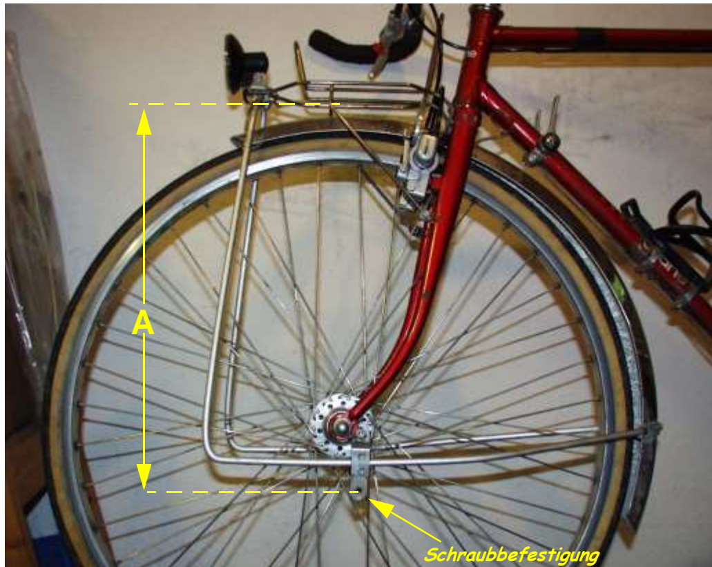
Bild 2 Rucksackmontagemöglichkeit am Gitane-Tandem vorn
