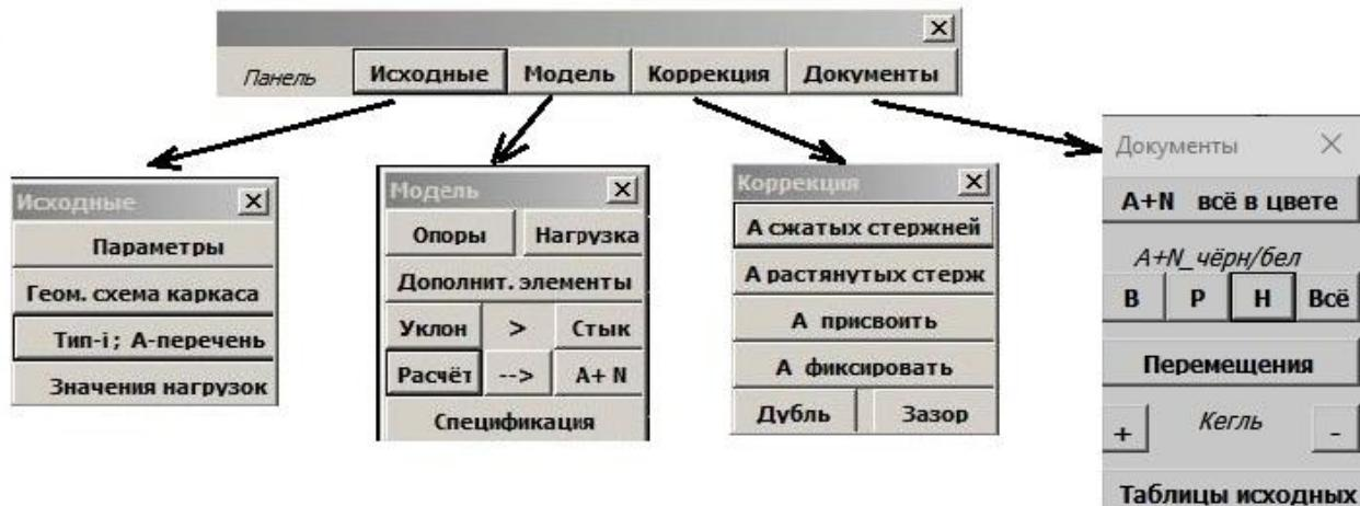
4.2.1 Нажатием клавиши **Параметры** на панели «**Исходные**», получаем список основных параметров, характеризующих каркас и материал, из которого он выполнен. Исходные параметры приняты для **N\_2015** по умолчанию согласно СП 16.13330.2011 [42].
